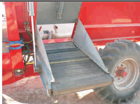
Descarga: Cinta transportadora, puerta tipo guillotina, lonas de contención.
