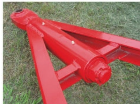
Punta de lanza con sistema compensador.
