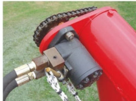
Motor hidráulico con multiplicador de velocidad.
