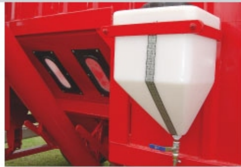
Depósito para inoculante y visores.
