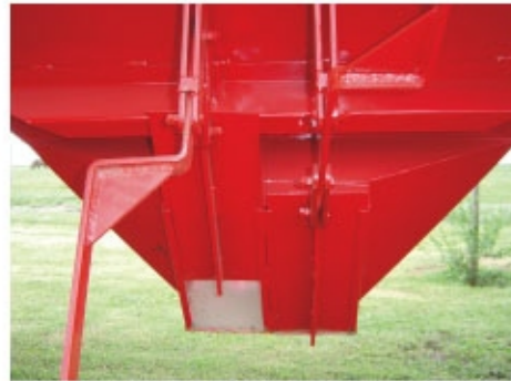
Boquillas de descarga.
