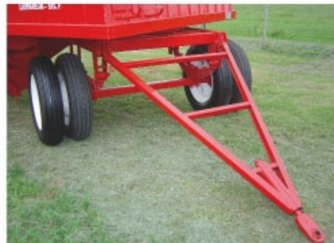
Lanza y tren delantero con aro giratorio a bolilla de 870 mm.
